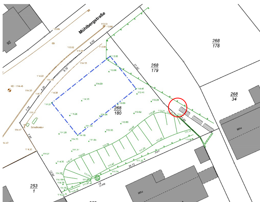
Abbildung 1 - Einmessung der bestehenden Treppenanlage. Der rote Kreis markiert die Anschlussstelle, die eher Grundstücksseitig verläuft
